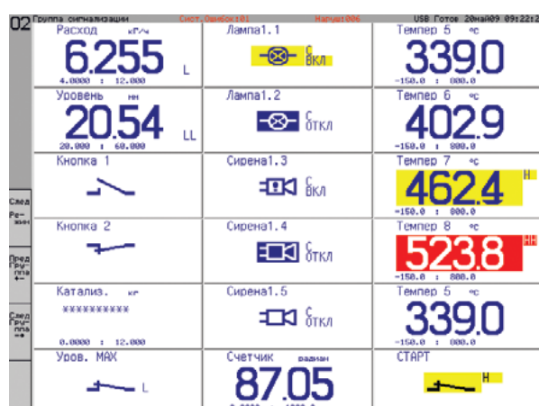
Рис. 2.9. Примеры представления информации на экранах контроллера БАЗИС-21.ЦР, БАЗИС-21.2ЦР
