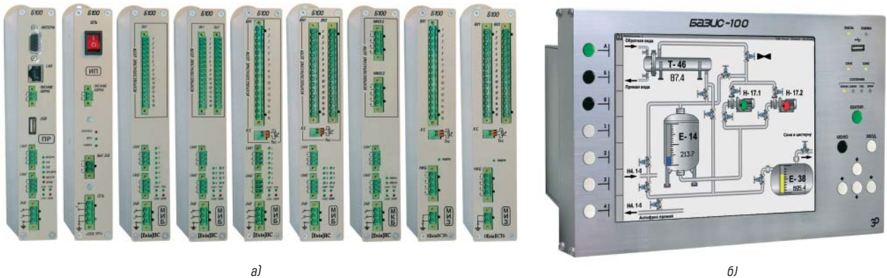
Рис. 1. Внешний вид ПЛК БАЗИС-100: а) основные модули; б) модуль ПУ
